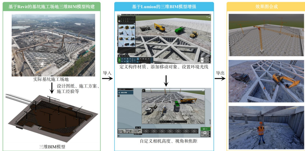
图 1 基于 BIM 的施工场地效果图生成流程
